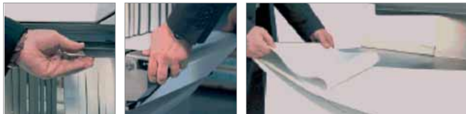
Cambio del nastro senza utensili – risparmio di tempo e garanzia di igiene.
