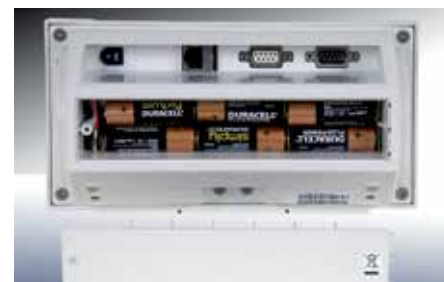
D 70 E vano batterie
